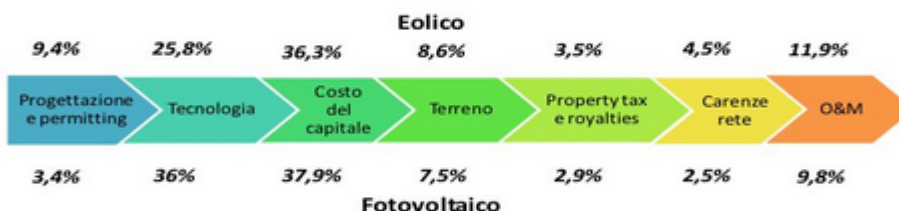
Figura 3.1 Struttura dei costi di produzione (LCOE) di eolico e fotovoltaico
