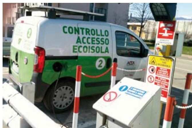
Figura 3 - Rifornimento di metano con ricarica lenta, una soluzione interessante per mezzi pubblici e di servizio alimentati a biometano (ACEA Pinerolese).
